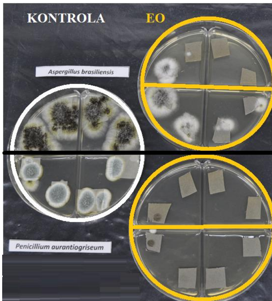
Obr. 10: Test s výstřižky z knihy. V horní části snímku je kontrola a dva vzorky plísně A. brasiliensis , v dolní části snímku kontrola a dva vzorky plísně P. aurantiogriseum . Na každé sadě 4 nosičů byly naneseny přibližné počty spor 10^6 , 10^5 , 10^4 a 10^3 (zleva).
