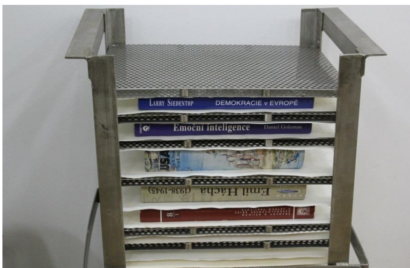
Obr. 4: Uspořádání knih a separačních desek v kontejneru při dezinfekci
