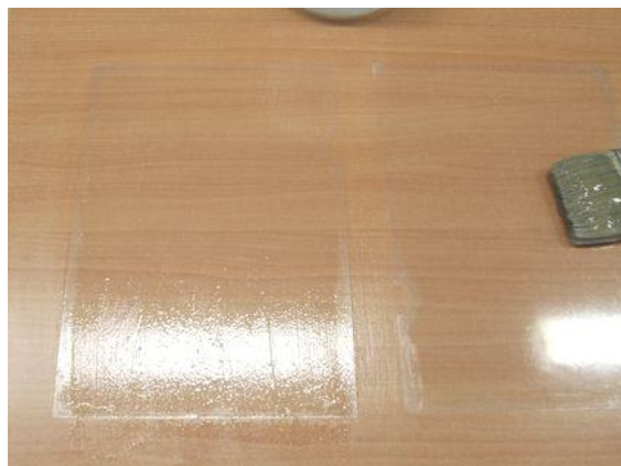
Obr. 4 /Rozetřená vrstva lepidla na plastové podložce
