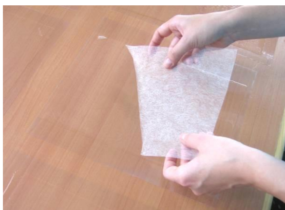
Obr. 15 /Pokládání japonského papíru na vrstvu lepidla.
