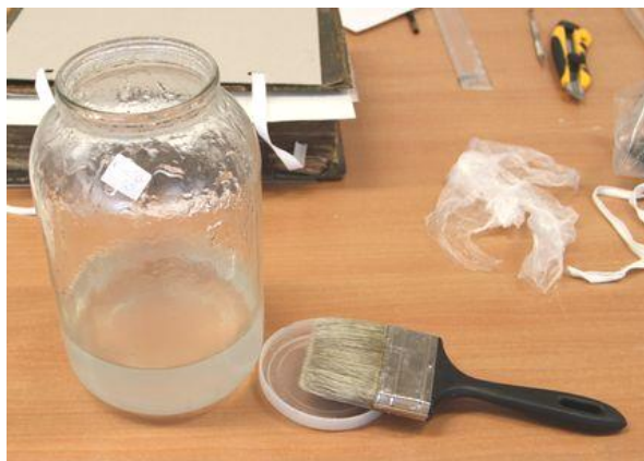
Obr. 3 /Zásobník lepidla (Klucel G v ethanolu) s plochým nanášecím štětcem
