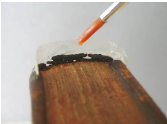
Obr. 31 /Zvlhčení proužku AJF z lepivé strany aktiváč. roztokem
